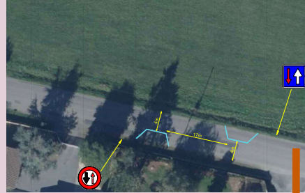
Au milieu de la rue : une écluse double, 100 m avant le rond-point, rue de Chantalouette
